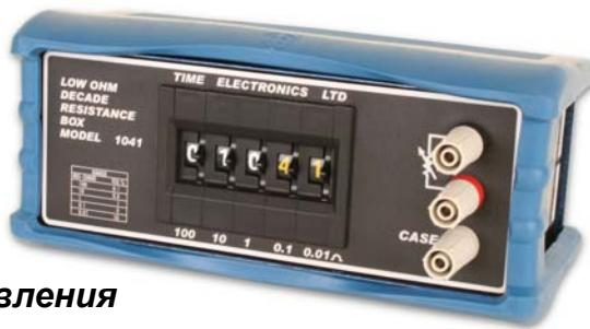
Модель Time Electronics 1041 представляет собой прецизионный магазин сопротивлений в прочном компактном корпусе, предназначенный для использования в производстве и для обучения. Обладая диапазонами малых сопротивлений, модель 1041 идеально подходит для имитации платиновых термометров сопротивления.
